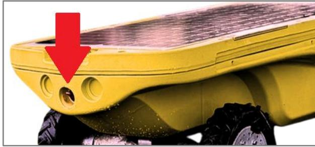
Transportez le robot de tonte VITIROVER de manière naturelle en plaçant vos deux mains sous les panneaux solaires de chaque côté du robot. Dans ce cas-là, le robot penchera vers l'avant, cela étant dû à la présence du bloc de tonte qui amène un surpoids.
